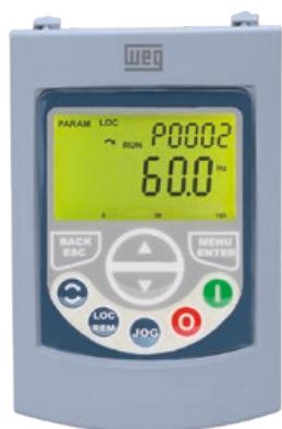
Interface de operação (IHM) remota (acessório CFW500-HMIR)
